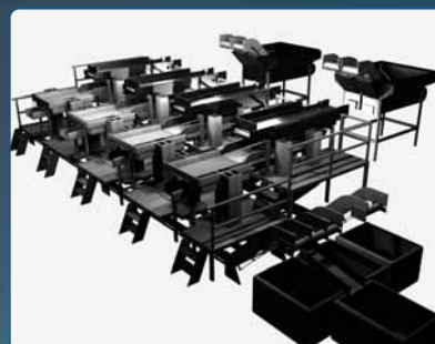
Mottaksstasjon for 4 båter, med 2 bulkløftere og system for sortering av biprodukter.
